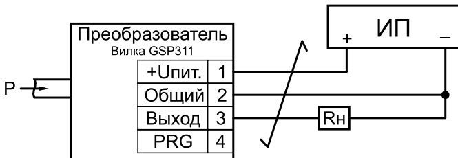
Рис. 3.3. Схема подключения преобразователя СЕНС-СДВ-0,4-2В
