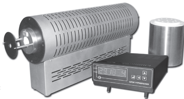
печь трубчатая ПТ с установленной диафрагмой
