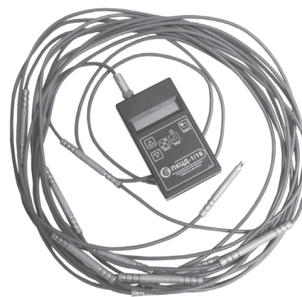
ПКЦД-1/16 с многозонным цифровым датчиком температуры МЦДТ 0922
