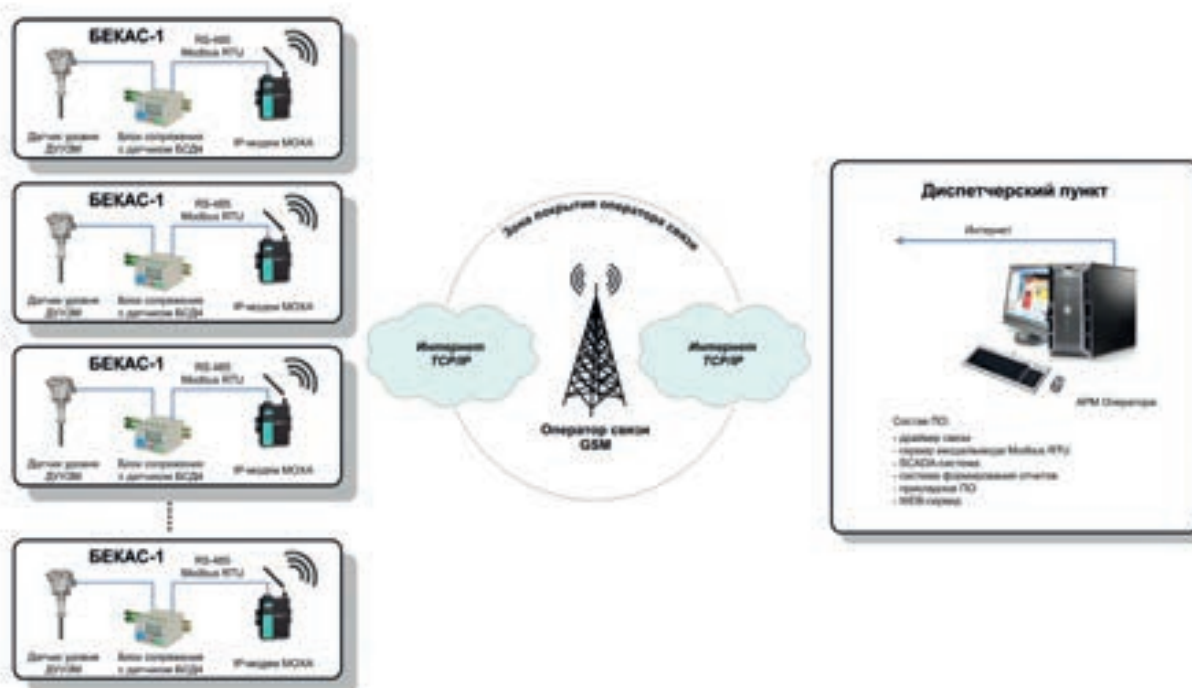
Рисунок VIII.6.1 – Схема комплекса сигнализации уровня БЕКАС-1
