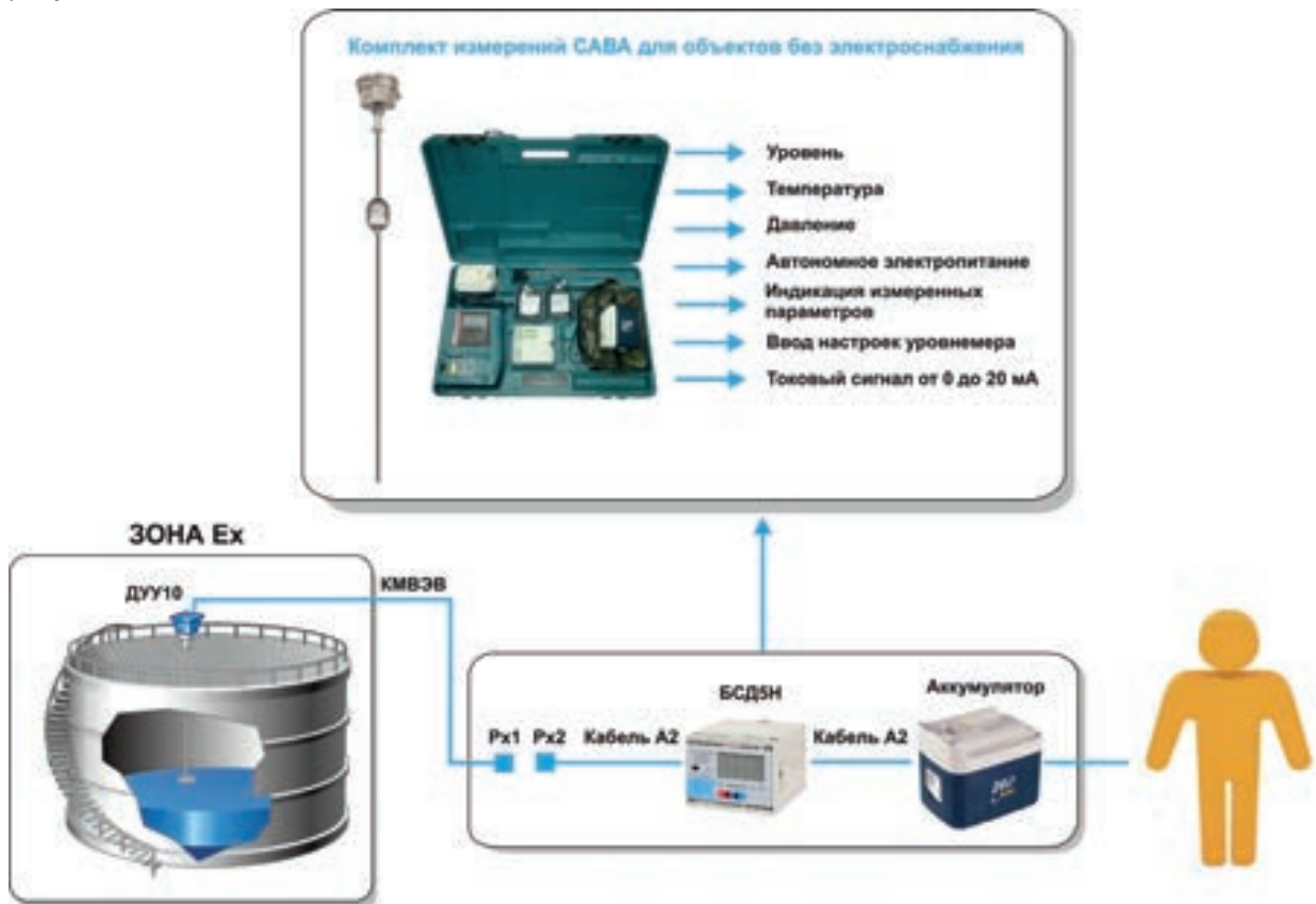
Рисунок II.14.1 - Схема подключения уровнемеров ДУУ10 (HART-протокол) и комплекта измерений САВА для объектов без электроснабжения
