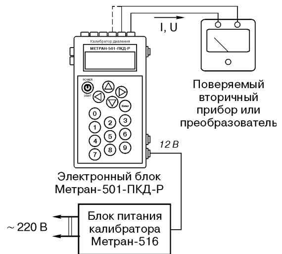
Рис. 7. Поверка и калибровка регистраторов и т.п.
