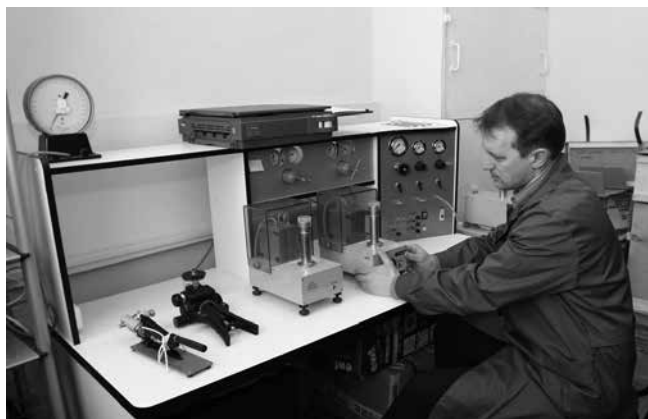
Первичный осмотр задатчиков давления Воздух-1600 1992 г. вып., производства ВНИИМС, г. Москва
