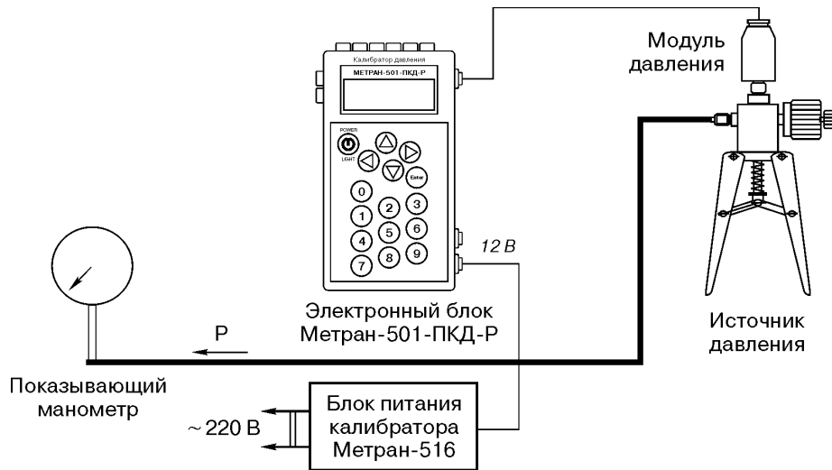
Рис. 5. Поверка и калибровка показывающих манометров.
