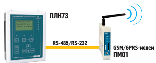
Подключение внешних устройств (например, GSM-модема)
