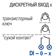
Схема подключения дискретных входов ПЛК100
