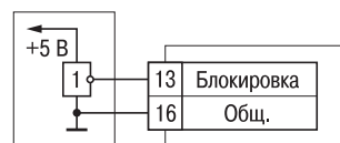
Устройство, имеющее на выходе сигнал TTL-уровня
