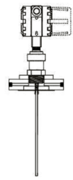
Рис. 6. Rosemount серий 3300/5300 с промывочным/продувочным соединением.
