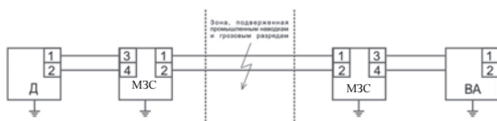
СХЕМЫ ВНЕШНИХ ЭЛЕКТРИЧЕСКИХ СОЕДИНЕНИЙ МЗС
