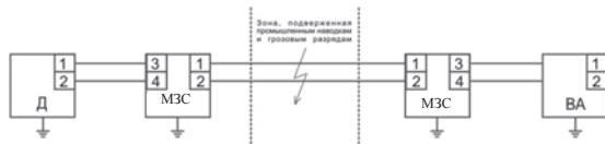
СХЕМЫ ВНЕШНИХ ЭЛЕКТРИЧЕСКИХ СОЕДИНЕНИЙ МЗС
