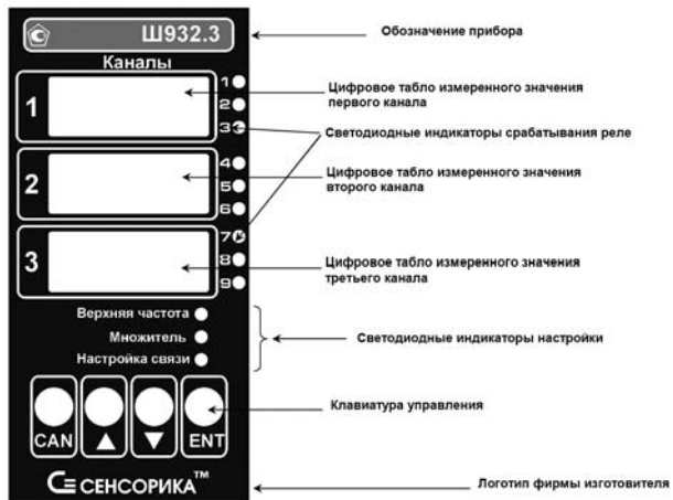
Рис. 3.2.1. Лицевая панель прибора Ш932.3
